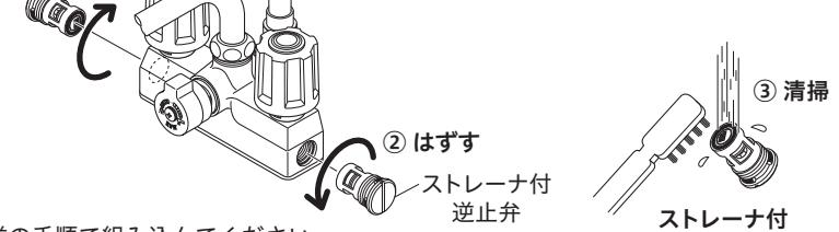
清掃後は、上記と逆の手順で組み込んでください。ストレーナを締め込む時、吐水切換ハンドルを吐水口側にしてください。
